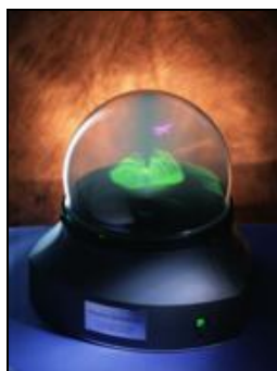
Abb.3: „Perspecta“ – erstes kommerzielles volumetrisches Display ( www.actuality-systems.com )
