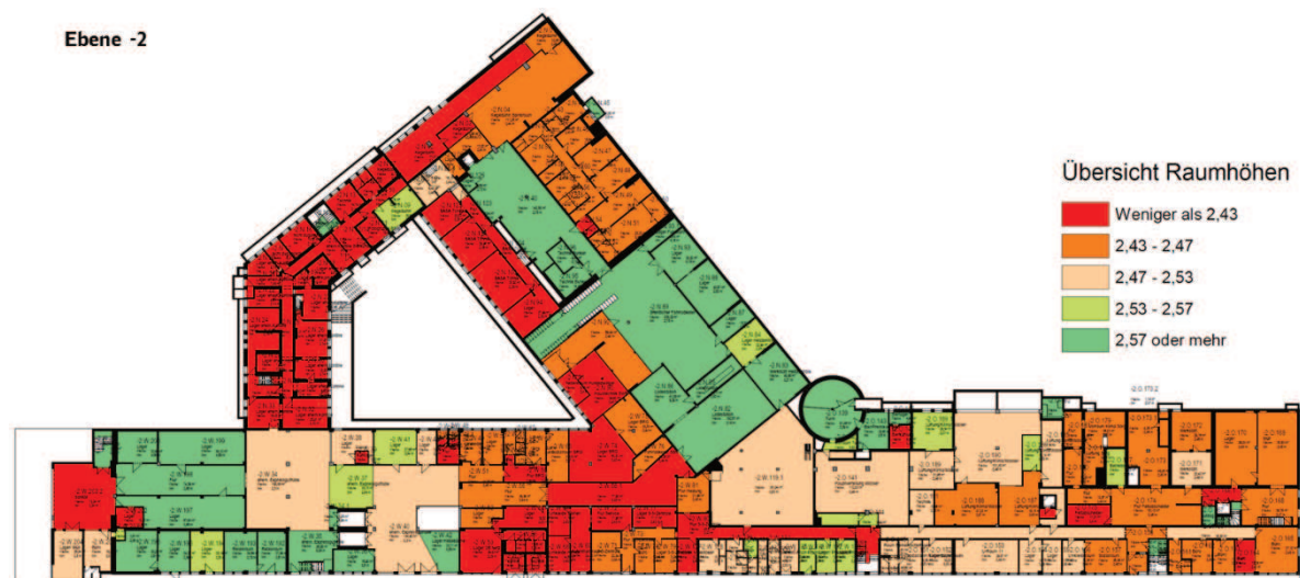
Abb. 17 Übersicht Raumhöhen Bestand. Direkt aus dem Bestandsmodell generierte Plangrundlage. Diese diente zur Verdeutlichung, der geringen Raumhöhen in zahlreichen Bestandsräume
