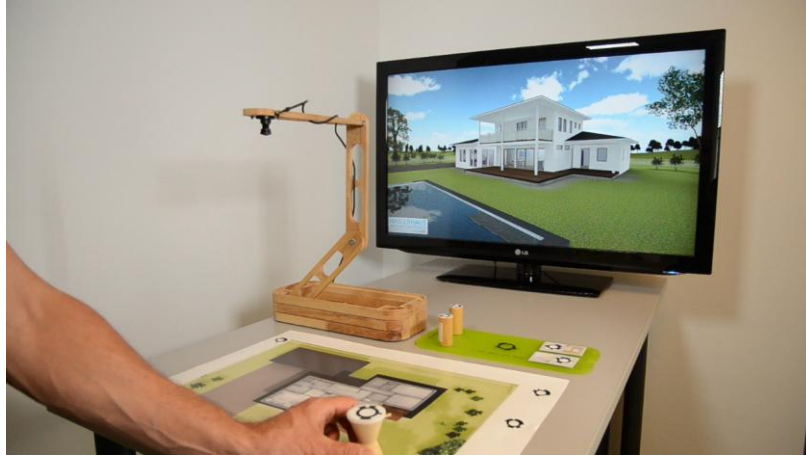
Fig. 1: Entwurf und Simulation in einer Realtime-3D-Anwendung mit „Natural Interface“
