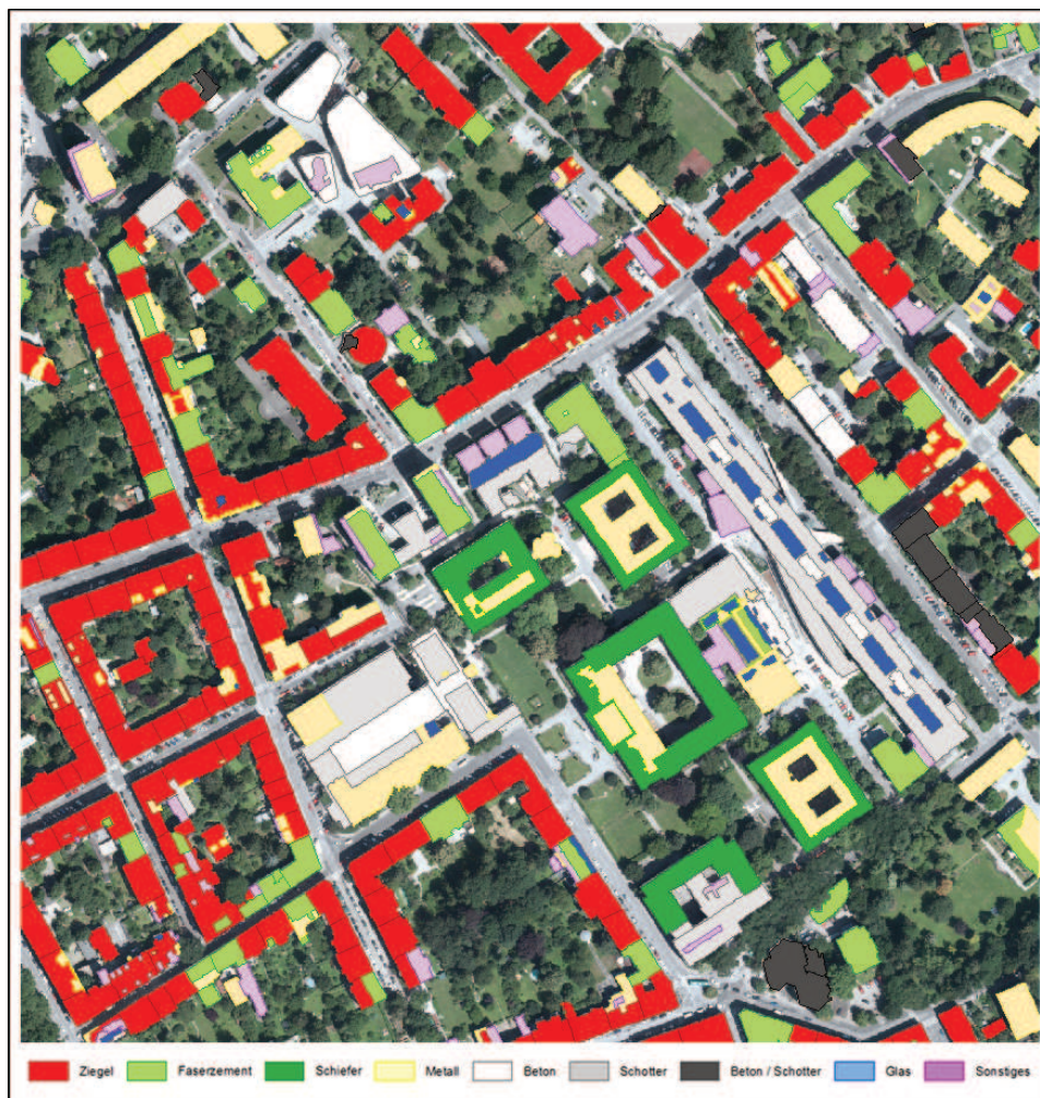
Fig. 3: Ergebnis der Dacheindeckungsklassifikation.
