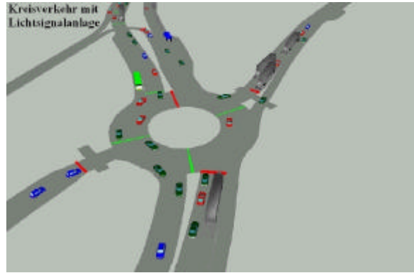
Abb.3: Kreisverkehr mit Lichtsignalanlage und Busbevorzugung
