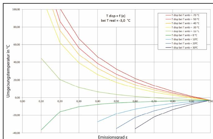
Fig. 6: Angezeigte Temperatur (T disp) in Abhängigkeit von der Umgebungstemperatur (T amb) bei unterschiedlichen Emissionsgraden  $\epsilon$  (MUDRI, 2014b).
