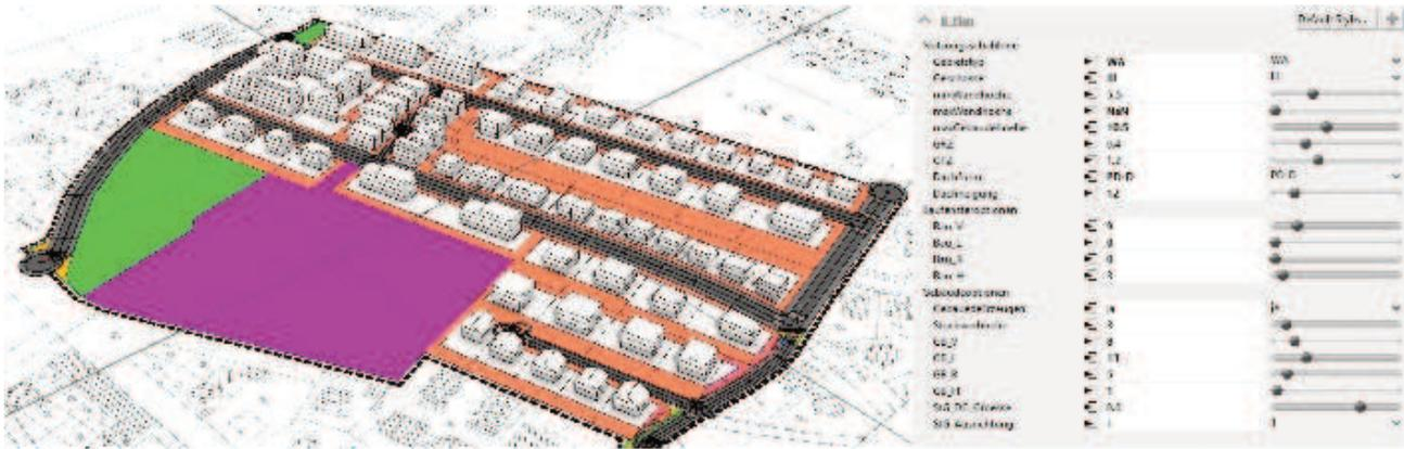
Abb. 7: Modellierter Bebauungsplan in CityEngine und Menü einer zugehörigen erstellten Regel für die parametrische Bearbeitung (Eigene Darstellung)
