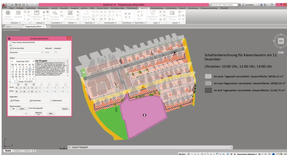
Abb. 5: Ermittlung und Darstellung des Schattenwurfs (Eigene Darstellung)
