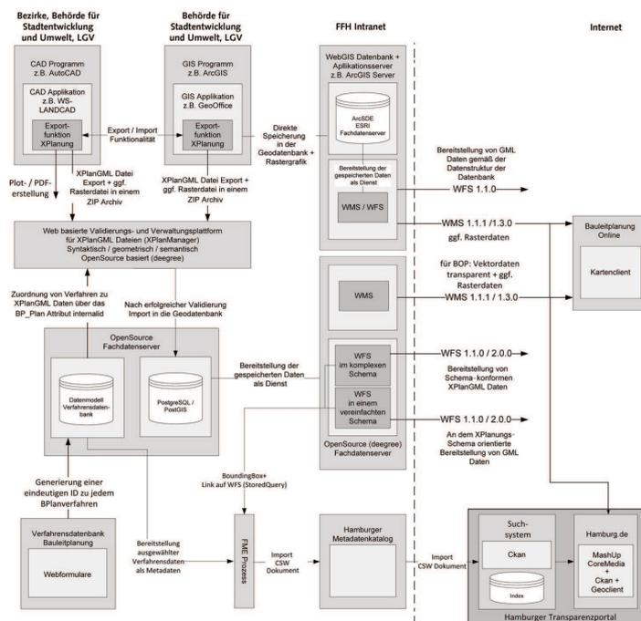
Abb. 2: IT-Architektur zur Erfassung und Bereitstellung von Bebauungsplänen in Hamburg (Quelle: Krause, 2014)
