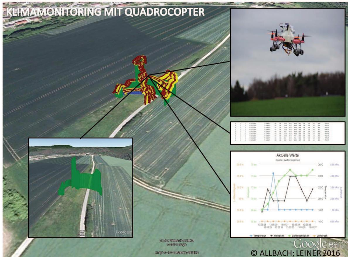
Abb. 6: Der Copter als Sensing-Plattform [EIGNENE DARSTELLUNG, 2015, 2016].
