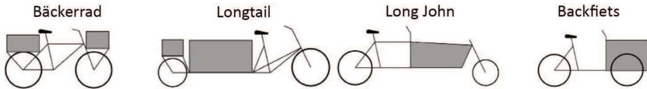
Abbildung 1: Überblick über weit verbreitete Bauweisen von Lastenrädern anhand gängiger Klassifizierungsmerkmale
